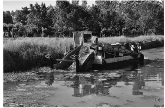
L'évacuation se fait directement dans un camion sur berge par l'intermédiaire d'un tapis latéral. Cette technique permet de récolter mécaniquement une biomasse végétale importante.
